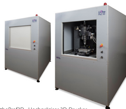
LithoProf3D - Hochpräziser 3D-Drucker Quelle: Multiphoton Optics GmbH
