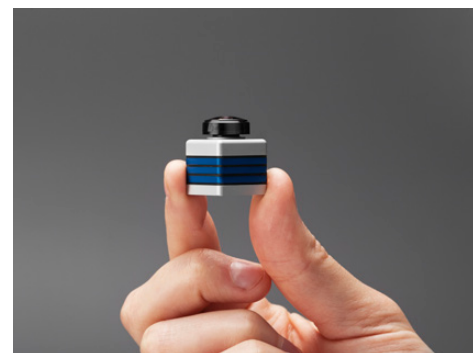
Knappe 6 cm 3 , um Personen auf vollständig autonome Art und Weise zu erkennen und zu identifizieren. Quelle: CSEM
